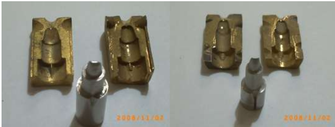
الشكل(2) القالب النحاسي المستخدم للحصول على نماذج شمعية متساوية السماكة
