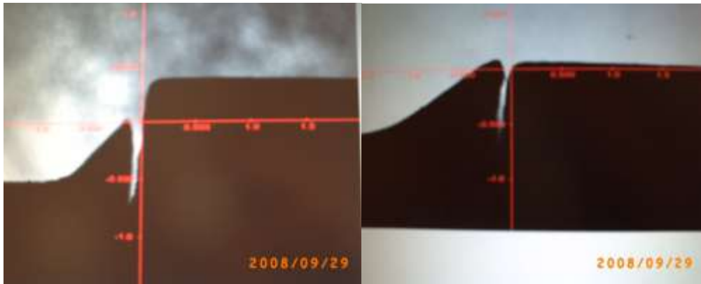
الشكل ( 6 ) صورة لعينتين تبين النقص والزيادة في الحواف في حالة التحضير بشكل كتف
