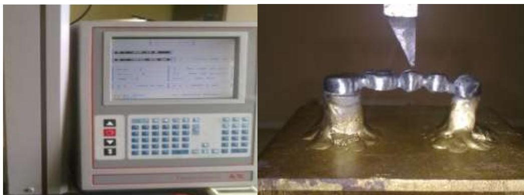
الشكل 8: آلة الاختبارات الميكانيكية العامة في كلية الهندسة الميكانيكية، بجامعة حلب (universal testing machine)
