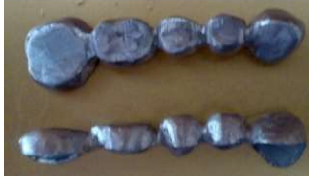
الشكل 3: السماكة العامودية، والأفقية للوصلات الثابتة في المجموعة الأولى.
