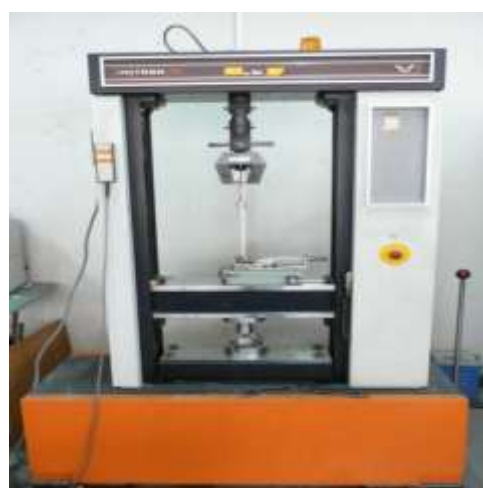
الشكل (4) طريقة تثبيت العينة على قاعدة الجهاز
