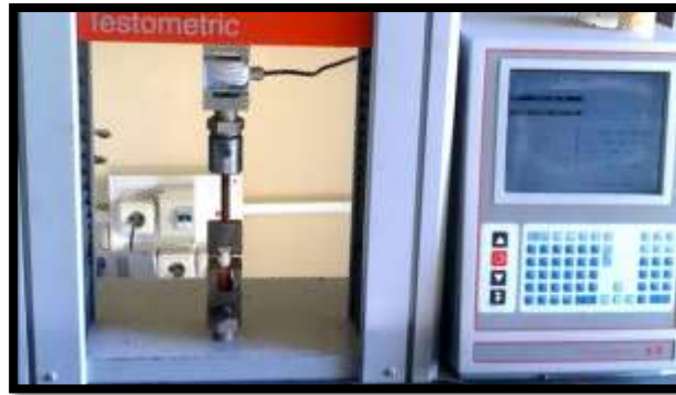
(شكل 9) أحد العينات مثبتة على جهاز الاختبار
