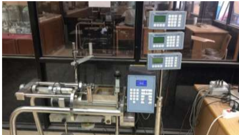
الشكل [3]: الجهاز(Tecnotest) المستخدم في قوى القص
