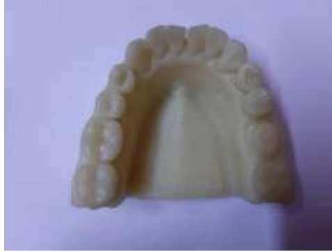
الشكل رقم (8): مثال مصنوع من الراتنج باستخدام تقنية الطباعة ثلاثية الأبعاد
