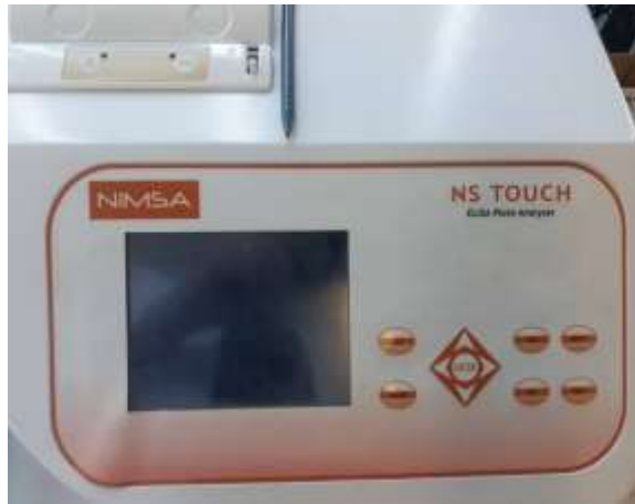
الشكل رقم (6): ELISA Plate Analyzer (جهاز قراءة الامتصاصية الخاص بالـ ELISA)
